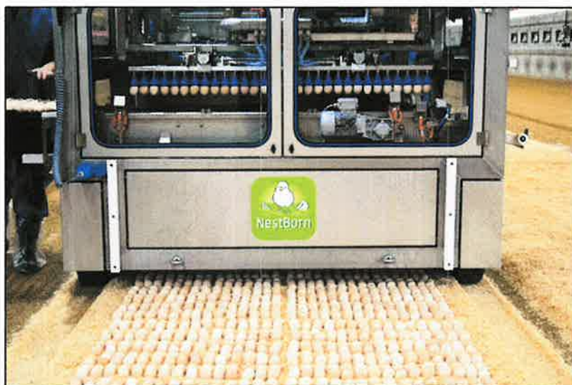
Photo 30: vue d'une machine « Nestborn » déposant les œufs prêts à éclore
