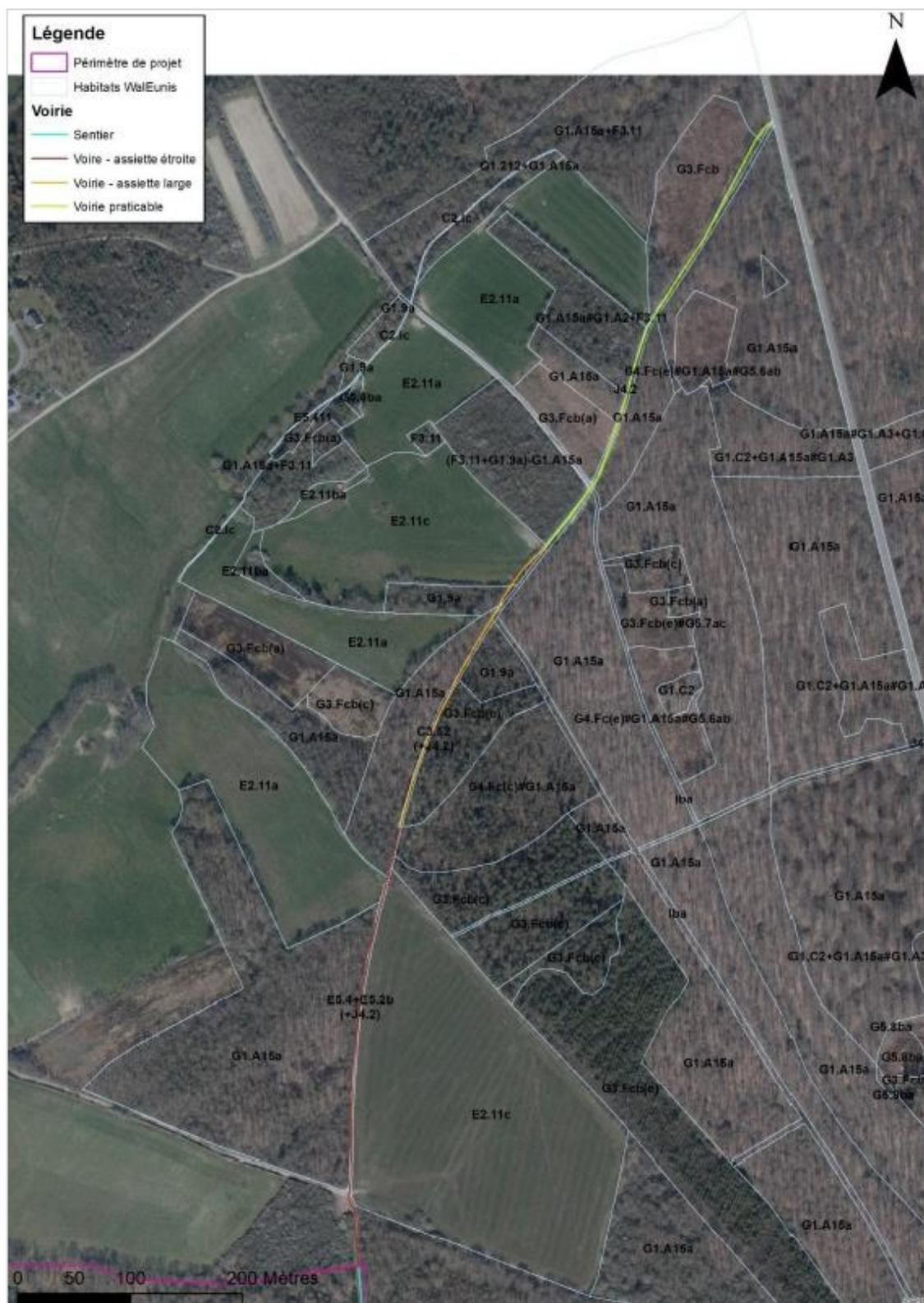
Sa viabilisation nécessitera un aménagement complet du chemin actuel (sur  $\pm 1.060$  mètres), d'un accotement (au minimum) afin d'élargir la voirie pour l'accès aux services de secours, d'aires de croisement et d'un fossé d'écoulement des eaux.
